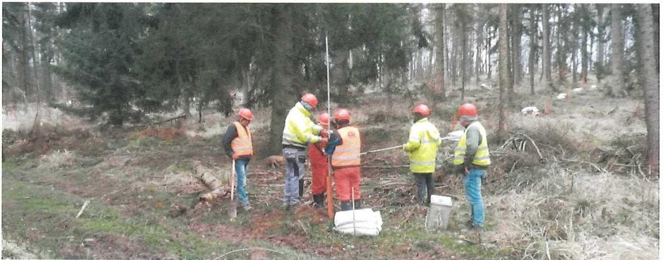
Abbildung 9: Laden der Bohrungen für die sprengseismische Anregung.
