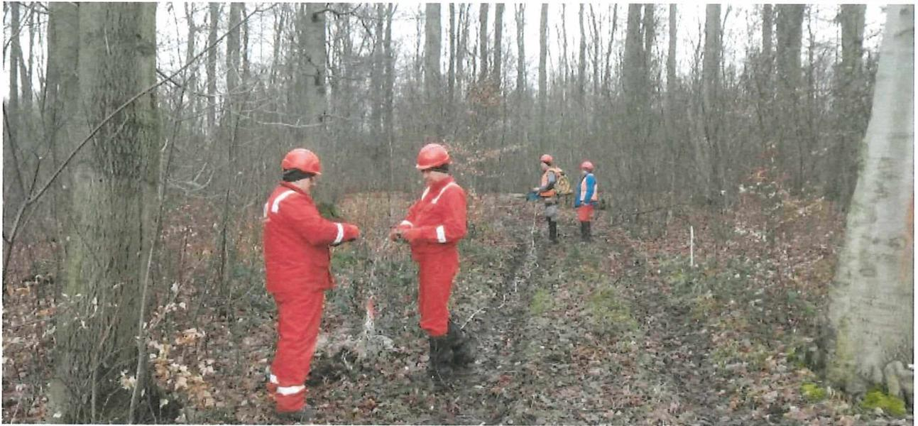
Abbildung 10: Prüfen der Zündkabel für die sprengseismische Anregung.
