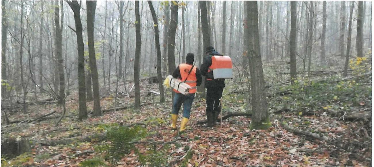
Abbildung 6: Vermessungsarbeiten im Wald mit dem Inertialsystem ZUPT.
